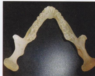
Фото 3.15. Стереолітографічна модель, виготовлена на 3D-принтері Objet з матеріалу FullCure 720 ( a, б )
